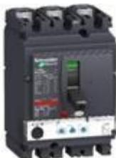
Disjuntor tripolar em caixa moldada, curva C, ajustável com disparador termomagnético e eletrônico, corrente nominal 220A, tensão de operação 690V, tensão de isolamento nominal: 800V, tensão suportável de impulso nominal: 8kV, capacidade de corte: 35kA em 440V, proteção contra sobrecorrente e curto-circuito. Referência: NSX250F TM80D 3P3D da Schneider ou equivalente.
