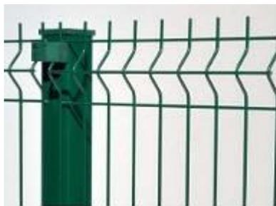
A malha possui dimensões externas de 2,03m x 2,50m (altura x largura), fixadas em postes metálicos de 2,50m de altura, com base de perfil retangular de dimensões de 60mm x 60mm (Ref. Nylofor da Cercas e Cia da Belgo, ou equivalente).
