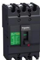
Disjuntor tripolar em caixa moldada, ajuste fixo, corrente nominal 40A, curva C, tensão de isolamento nominal: 690V, tensão suportável de impulso nominal: 6kV, capacidade de corte: 16kA em 415V, proteção contra sobrecorrente e curto-circuito. Referência: EZC100N 3P 40A da Schneider ou equivalente.
