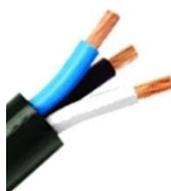
Cabo com 3 vias de diâmetro de 10mm<sup>2</sup> cada, formado de fios de cobre eletrolítico, de alta condutividade (99,9%), seção circular, têmpera mole, com isolamento da classe 0,6/1 kV com isolamento, enchimento e cobertura em PVC, 90° C de temperatura de serviço contínuo, não propagação e autoextinção do fogo.
