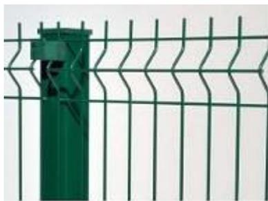
A malha possui dimensões externas de 2,43m x 2,50m (altura x largura), fixadas em postes metálicos de 3,20m de altura (0,72m de chumbamento e 2,48m de altura livre), com base de perfil retangular de dimensões de 40mm x 60mm (Ref. Nylofor da Cercas e Cia da Belgo, ou equivalente).
