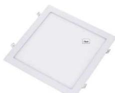
Luminária de LED 24 W tipo plafon completa (módulo led integrado, drive bivolt incluso, presilhas para fixação no gesso e PVC – não precisa de lâmpada). O plafon em LED de embutir dispensa acabamento externo, o corpo é em alumínio branco fosco com pintura eletrostática. Fluxo luminoso mínimo de 2160 lumens, temperatura de cor branca quente 6500 K, IRC  $\geq 85$ , FP  $\geq 0,9$ , vida útil  $\geq 50.000$  horas, dimensões aproximadas de 30 x 30 x 1,3 cm (CxLxP).
