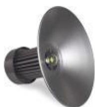
Luminária industrial em LED completa, corpo em alumínio, potência de 200W, fator de potência  $>0,95$ , bivolts, 20000 lúmens, ângulo de abertura 120°, temperatura de cor 6000K, vida útil mínima 30000h. Módulo LED e drive inclusos.
