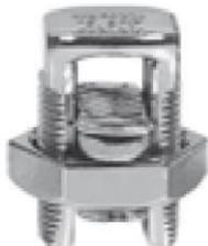
Conector de pressão do tipo parafuso fendido (Split-Bolt) em cobre natural para cabos de até 35mm<sup>2</sup> (Referência: TEL 5015 Termotécnica).
