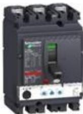
Disjuntor tripolar em caixa moldada, curva C, ajustável com disparador termomagnético e eletrônico, corrente nominal 150A, tensão de operação 690V, tensão de isolamento nominal: 800V, tensão suportável de impulso nominal: 8kV, capacidade de corte: 35kA em 440V, proteção contra sobrecorrente e curto-circuito. Referência: NSX160F TM80D 3P3D da Schneider ou equivalente.
