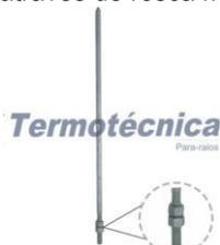
O minicaptor terá haste captora de 600 mm de altura, diâmetro nominal 10 mm, base em rosca mecânica, fabricado em aço galvanizado a fogo (Referência: TEL 2058 Termotécnica).
