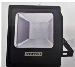
Projetor de sobrepor em piso, parede ou cruzeta, com potência máxima de 50W. Temperatura de cor de 6500K. Fluxo luminoso mínimo de 2700lm. IRC >80. Vida útil mínima > 25.000 horas. Temperatura de operação: -10°C a 45°C. Corpo em alumínio e difusor de vidro. Vedação em silicone. Índice de proteção da luminária IP65. Facho luminoso mínimo de 110°. Referência: LED LUNA 2 07552 da INTRAL ou equivalente.
