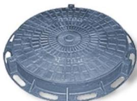
Os tampões de fechamento serão de ferro fundido dúctil, do tipo leve e/ou pesado, com diâmetros e seções variáveis, de acordo com o projeto de instalações hidrossanitárias. As classes de resistência devem atender as solicitações do tráfego mais leve (classe A15 - carga de ruptura > 125 kN) ao mais pesado (classe E 600 - carga de ruptura > 600 kN), para utilização em calçadas, ruas e vias de circulação.
