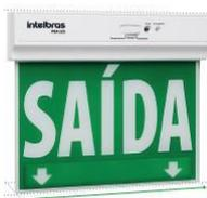
Bloco autônomo de emergência de LED com a palavra SAÍDA grafada em letras brancas com fundo verde em placa de acrílico transparente, mínimo 8 LEDs alto brilho, 100-240 VCA, 50-60Hz, autonomia de bateria de no mínimo 3 horas, 30lm. Módulo LED e drive inclusos.
