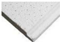
O serviço consiste no fornecimento e na instalação de forro removível em painel modular de dimensões 62,5 cm x 62,5 cm e 15mm de espessura, com sistema de apoio do tipo Tegular, fabricado a partir de lãs minerais na cor branca (Ref. Armstrong Sahara ou equivalente), nas áreas identificadas no desenho de teto refletido do projeto.
