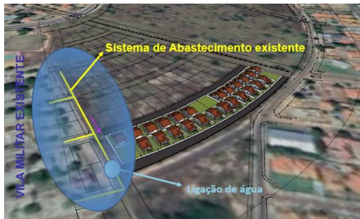
Figura 3 – Ligação do sistema de abastecimento de água potável da Via P6 à rede pública existente da CAER.
