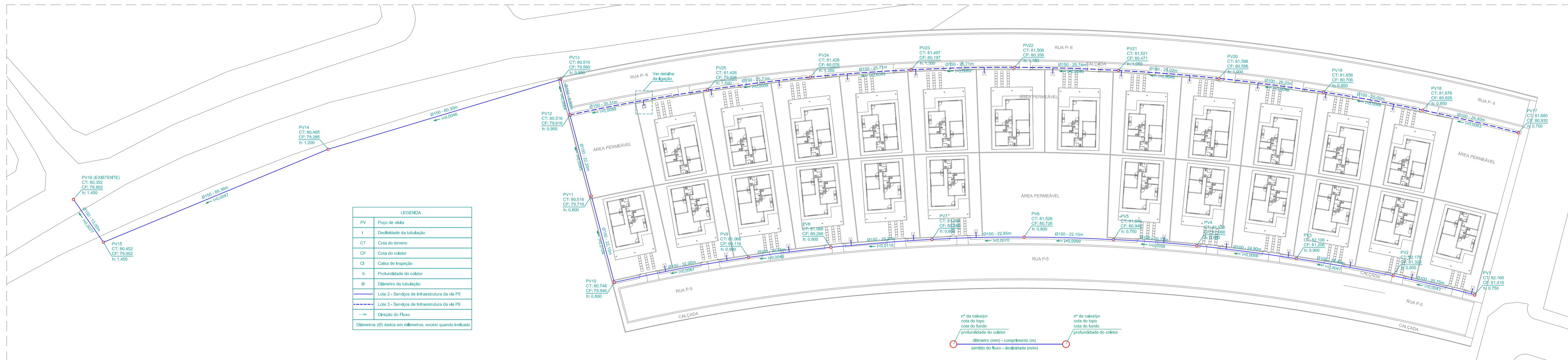
ESGOTO - REDE EXTERNA ESCALA: 1/500
