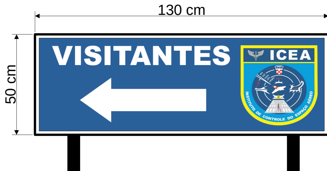
Placa acesso ICEA (ACM) Fig. 05
