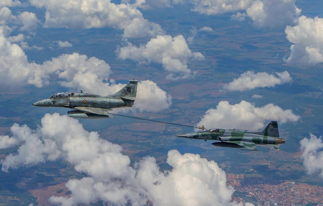
*REVO Body-Body com aeronave A-4 da Marinha e F-5 da FAB<sup>21</sup>*
