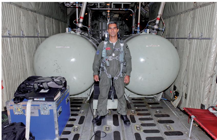
*Tripulante e tanques para REVO<sup>17</sup>*
