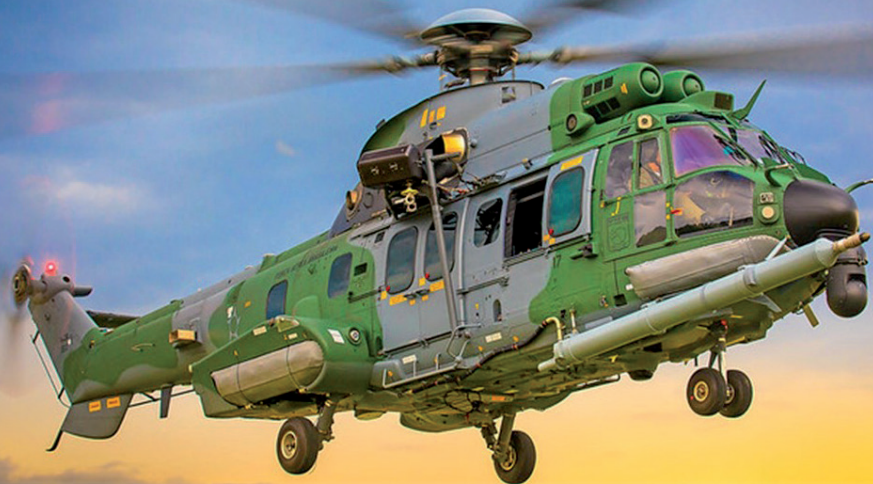
H-36 do 1º/8º GAv equipado com probe de REVO 54
