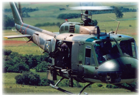
Configuração com 4 metralhadoras 7,62 mm laterais, 2 metralhadoras .30 e 2 metralhadoras .50 frontais 39
