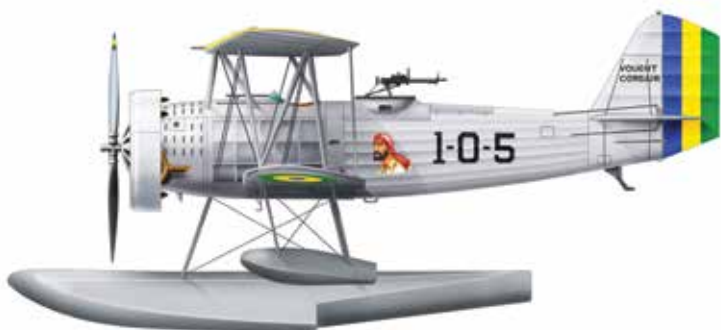
Corsário O2U-2A da Aviação Naval 1-0-5, dotado com carenagem no motor e flutuadores
