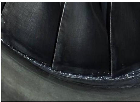
Depósitos de sal no compressor axial
