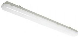
Luminária hermética de sobrepor em perfilado. Corpo em policarbonato, refletor em chapa de aço tratado com acabamento em pintura eletrostática na cor branca, difusor em policarbonato translúcido. Proteção IP-65. Bivolt. Driver incluso no corpo da luminária. Instalação em perfilado. (Referência: Itaim LPT 24).
