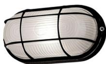
Arandela completa de sobrepor para instalação em aparente para uma lâmpada led compacta de 12W/220V, de comprimento 252mm, largura igual a 105mm e altura 87mm. Corpo e grade em alumínio injetado e pintura eletrostática a pó. Difusor em vidro temperado prismático interno e liso externo. Vedação em borracha de silicone. Grau de proteção (IP 54). Soquetes em porcelana e contatos em latão. Receptáculos para lâmpada led compacta. (Ref: Induspar código 204602 ou equivalente).
