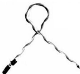
O serviço consiste no fornecimento e na instalação de emenda pré-formada utilizado para fixar a cordoalha de aço no isolador de roldana. Fabricados por fios de aço galvanizados e, na parte interna, devem possuir material abrasivo à base de óxido de alumínio. O coxim de elastômero que será aplicado sobre a cordoalha deverá estar incluso. A medição será efetuada unidade instalada.
