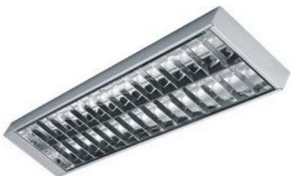
Fornecimento e instalação de luminária de sobrepor com aletas para duas lâmpadas LED Tubulares de até 20W, de dimensões 300 x 1235mm, com refletor em chapa de aço tratada e pintura eletrostática branca e alojamento do reator no corpo da luminária, completa, com lâmpadas (ref. TCS 020232CI00, da Philips ou equivalente).
