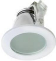
Luminária tipo LED de embutir, 16W, com 12cm de diâmetro, sendo de embutir em gesso, corpo em chapa de aço tratada e com pintura eletrostática epóxi na cor branca. (Ref: Spot LLUM ou equivalente).
