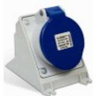
Tomada blindada 2 polos mais terra, 2P+T de sobrepor, 16A, 6H, 220V e grau de proteção IP44. Construção conforme NBR IEC 60309-1: 2015, que versa sobre plugues e tomadas para uso industrial. (Ref: STECK ou equivalente)
