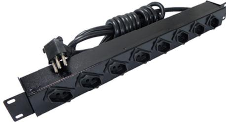
O serviço consiste no fornecimento e instalação de régua de tomadas para fixação em racks e gabinetes em data center e telecom, utilizada para conexão elétrica aterrada de equipamentos que possuam plug para alimentação com o novo Padrão Brasileiro (NBR 14136) de tomadas. Montadas com terminais fêmea padrão brasileiro (NBR 14136), com conectores individuais interligados através de barramento de cobre com diâmetro 1,50 mm e solda em estanho. Disponível com cabo de alimentação de 2 metros.
