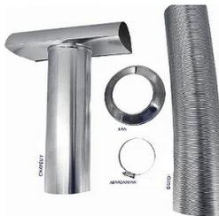
Este serviço consiste no fornecimento e na instalação de dutos de exaustão e condução dos gases de combustão para o exterior. Devem ser fabricados com materiais incombustíveis e suportar temperatura superior a 200°C, Ser resistente a corrosão (conforme normas ABNT NBR 8094 e NBR ISO 4628-3, aço inoxidável com 0,3 mm de espessura de parede ou em alumínio rígido com 0,5 mm de espessura de parede.
