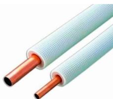
O serviço consiste no fornecimento e instalação de tubulação em cobre para interligação da unidade condensadora ao evaporador, diâmetros de 1 3/8" para linha de sucção e 1/2" para linha de líquido, isolamento térmico, conexões e fixações, para câmaras frias. Inclusive, válvula de expansão termostática manual, a ser instalada na entrada (linha de líquido) da evaporadora, válvula esta que contempla: faixa de temperatura -40°C a
