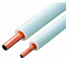
O serviço consiste no fornecimento e instalação de tubulação em cobre para interligação do condensador ao evaporador, diâmetros de 3/8” para linha de sucção e 1/4” para linha de líquido, inclusive isolamento, alimentação elétrica com cabo PP 3x2,5mm para interligação entre a condensadora e evaporadora, conexões e fixações, para condicionadores de ar split system até 12.000 BTU. Ref.: Daikin, Fujitsu, Elgin ou equivalente.
