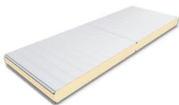
O serviço consiste no fornecimento e instalação de placas de isolamento térmico para câmara fria com núcleo em EPS (Poliestireno Expandido), Classe tipo 3F, condutividade térmica de 0,035 W/m.k e tolerância conforme na norma ABNT-NBR 11949-9, placas com largura de 1,1 m e comprimento de 6,5 m, revestimento em Aço INOX AISI 304 ou aço galvanizado, fosco (interno/externo), espessura 0,50 mm, conforme normas ABNT-NBR 7013 e ABNT-NBR 7008.
