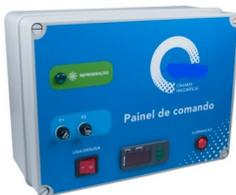
O serviço consiste no fornecimento e instalação de quadro de comando para resfriados de câmara fria, até 4 HP, trifásico, 380 V, 60 Hz, com interligação elétrica com fiação flexível, eletroduto rígido entre o quadro de comando, a unidade condensadora e evaporador, fixação de eletroduto, com distância total de até 17 metros entre as três unidades. O eletroduto, fabricado conforme a NBR 1465, deverá ser rígida, antichama, capaz de suportar cargas de até 320N/cm.
