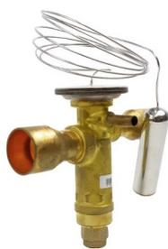
O serviço consiste no fornecimento e instalação de uma válvula de expansão termostática manual, a ser instalada na entrada (linha de líquido) da evaporadora, válvula esta que contempla: faixa de temperatura -40°C a +20°C, mesmo gás refrigerante a ser utilizado no sistema, conexão roscada, pressão máxima de trabalho 34 bar, conexão de entrada 3/8" a 1/2".
