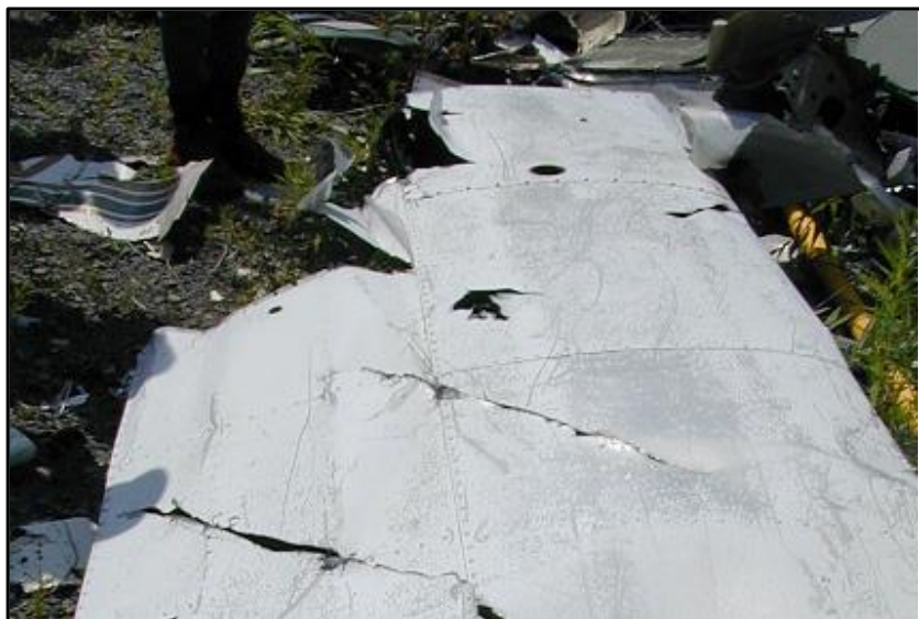
Figura 54 - Marcas equidistantes deixadas por uma hélice na asa de outra aeronave no momento da colisão em voo.
