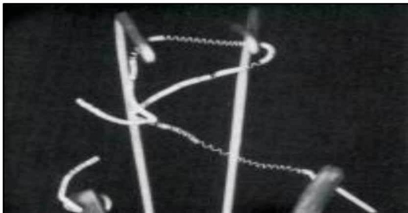
Figura 49 - Filamento que sofreu um curto-circuito com evidências de deformação local e generalizada.
