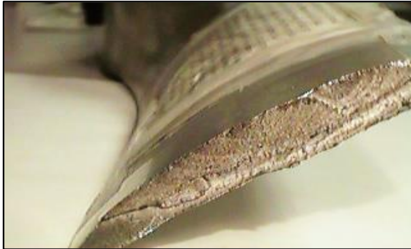
Figura 23 - Hélice com marcas de praia ( beach marks ) como resultado de falha por fadiga de ressonância.
