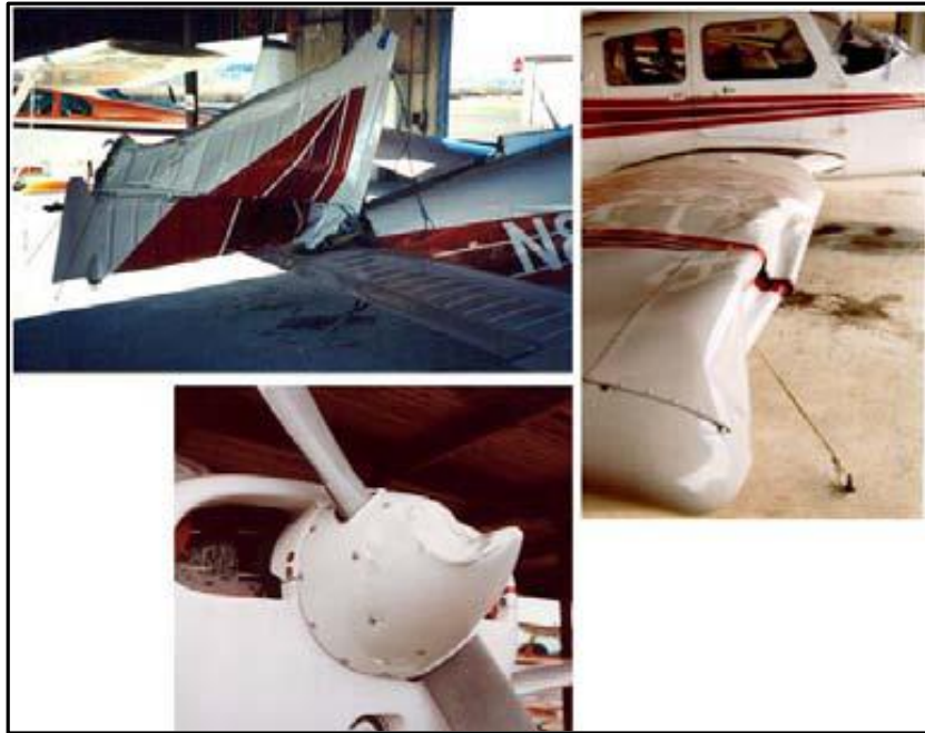
Figura 117 - A ductilidade em estruturas metálicas permite uma informação visual do acidente para o investigador.
