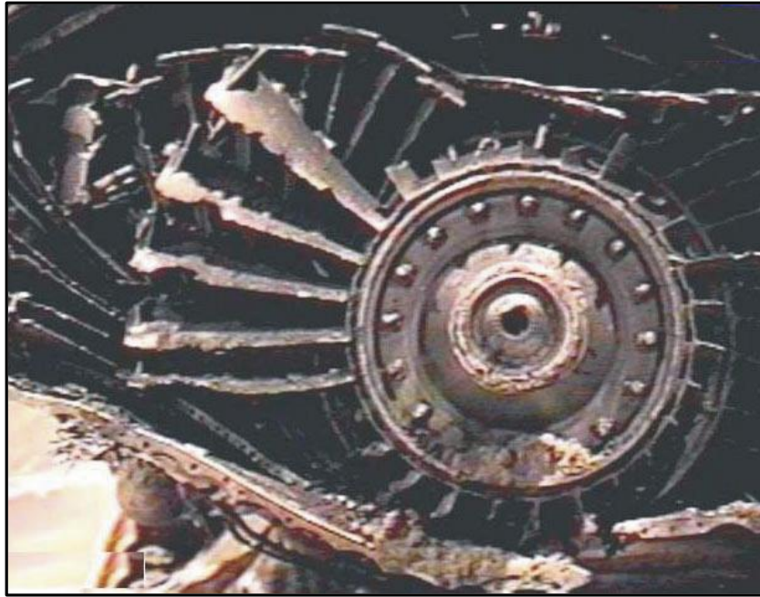
Figura 30 - Danos em baixa rotação sobrepostos aos danos em alta rotação.
