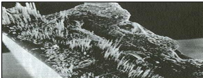
Figura 124 - Amostra de material composto que falhou por flexão. A área relativamente grosseira representa a falha por tração e a área relativamente suave representa a falha por compressão, e são claramente identificáveis.
