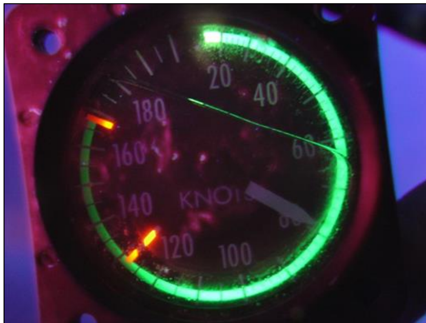
Figura 11 - Análise por meio da aplicação de luz negra em um airspeed indicator evidenciando marcas em seu mostrador.
