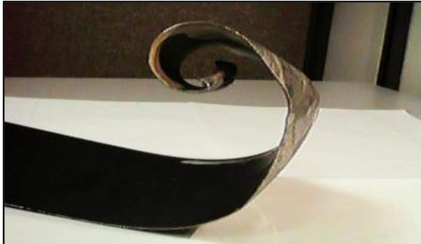
Figura 21 - Pá de hélice curvada para frente como resultado de alta RPM durante um impacto com baixo ângulo em terreno macio.
