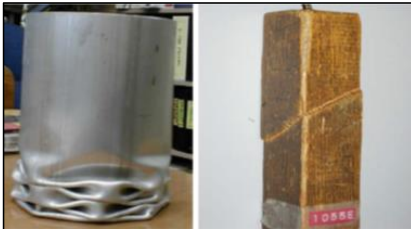
Figura 106 - Tubo vazado submetido a esforço de compressão - falha pelo modo de flambagem (esquerda); e Coluna de madeira submetida a esforço de compressão - falha por cisalhamento (direita).
