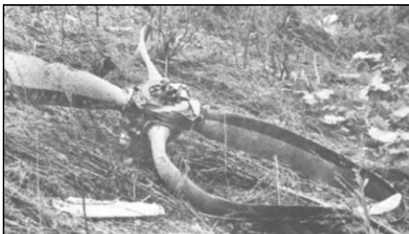
Figura 26 - Hélice metálica após o impacto (baixa potência).
