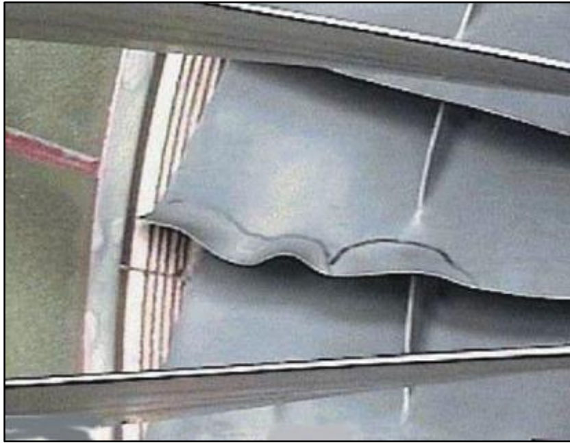
Figura 38 - Típico dano nas blades de um motor causado por gelo.
