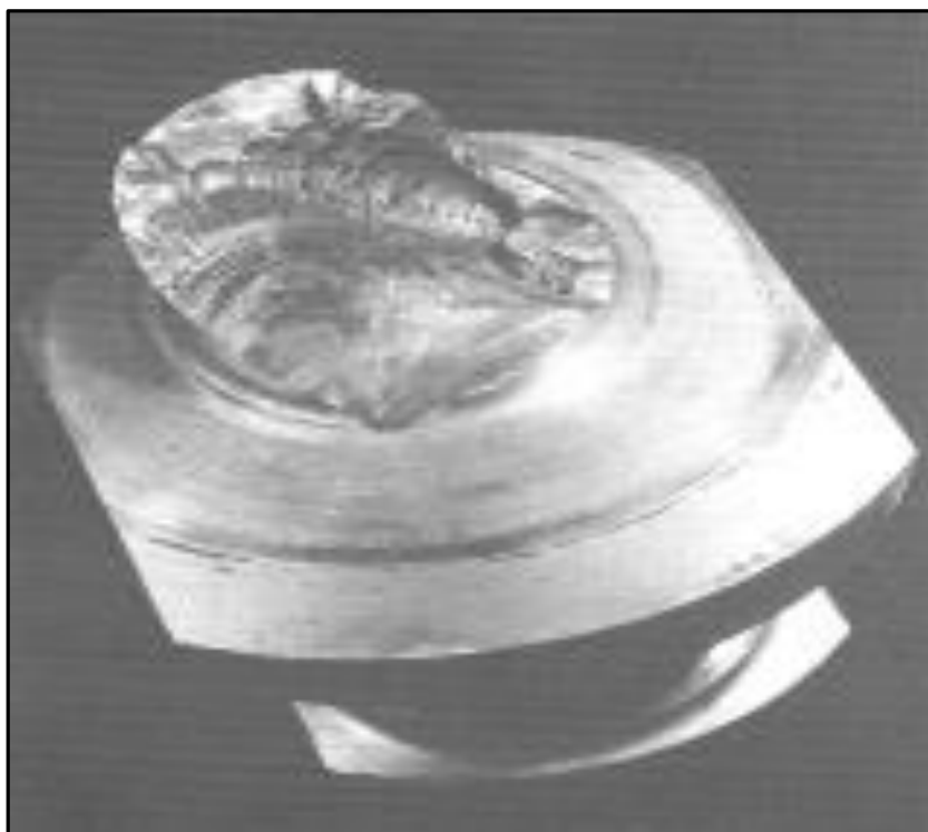
Figura 104 - Falha por fadiga de um eixo que foi submetido a esforços de torção e de flexão. A rachadura de fadiga originou-se de uma mudança de seção.
