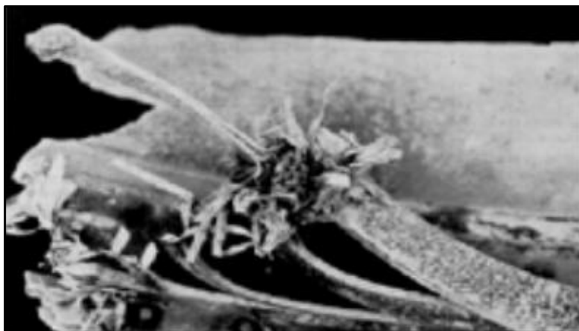
Figura 98 - Alumínio próximo ao estado de fusão " broomstraw ".
