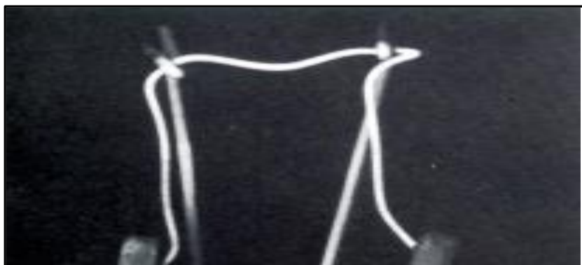
Figura 51 - Filamento novo sem sinais de deformação.
