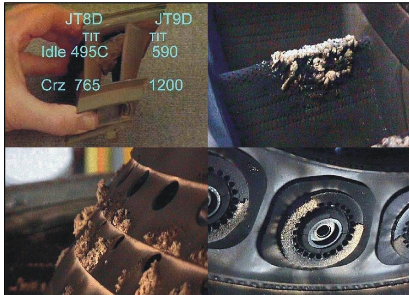
Figura 42 - Poeira vulcânica derretida e aderida nas partes quentes do motor.
