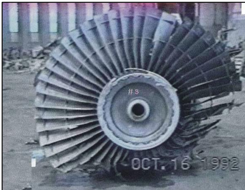
Figura 29 - Danos ao fan em baixa rotação.
