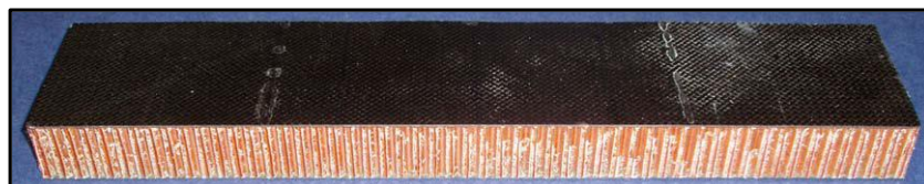
Figura 119 - Estrutura sandwich composta por um núcleo de honeycomb e material composto nas regiões externas.
