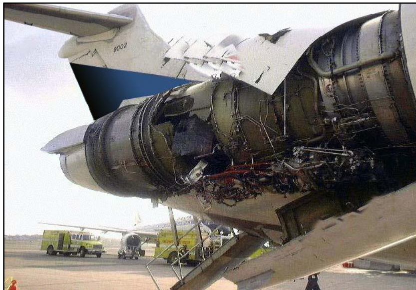
Figura 44 - Características de high pressure case fracture .
