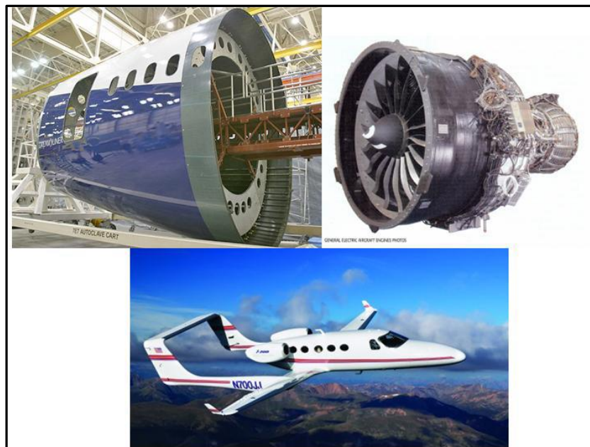
Figura 115 - Exemplos de Composite Structures (sentido horário a partir do canto superior direito): Boeing 787 fuselagem, General Electric GENx fan blades and case , Adam Aircraft A700 VLJ.
