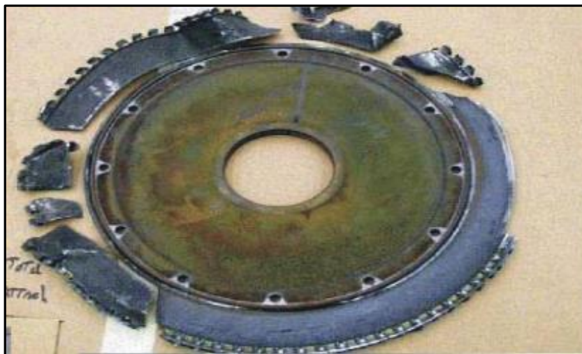
Figura 34 - Típico uncontained rotor disk failure com fragmentos de compressor.
