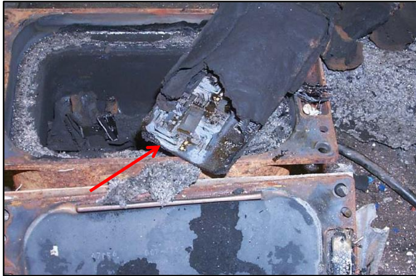
Figura 6 - Placa de memória de gravação danificada após fogo intenso.
