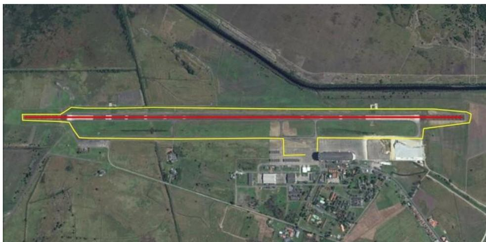
Figura D6 – Exemplo de circuito de transecto em aeródromo
