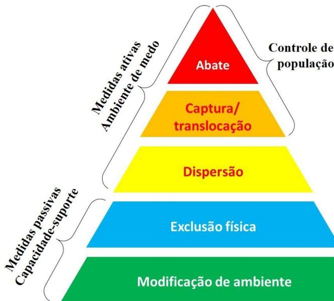
Figura 23 - Prioridade técnica de medidas de controle de fauna em aeródromos
