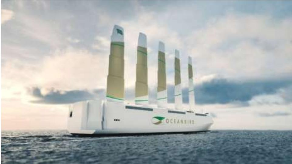
Chamado de **Oceanbird**, o navio tem um conjunto de cinco velas de aço que mais se parecem com as asas de um avião. Quando içadas, as velas alcançam uma altura de até 105 metros acima do nível do mar e são usadas para capturar a força do vento e impulsionar o navio no oceano
