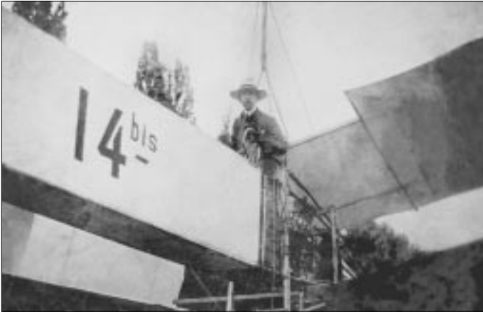
Santos-Dumont na cesta do 14-bis realizando os testes com o aparelho preso em um cabo inclinado. 1906
